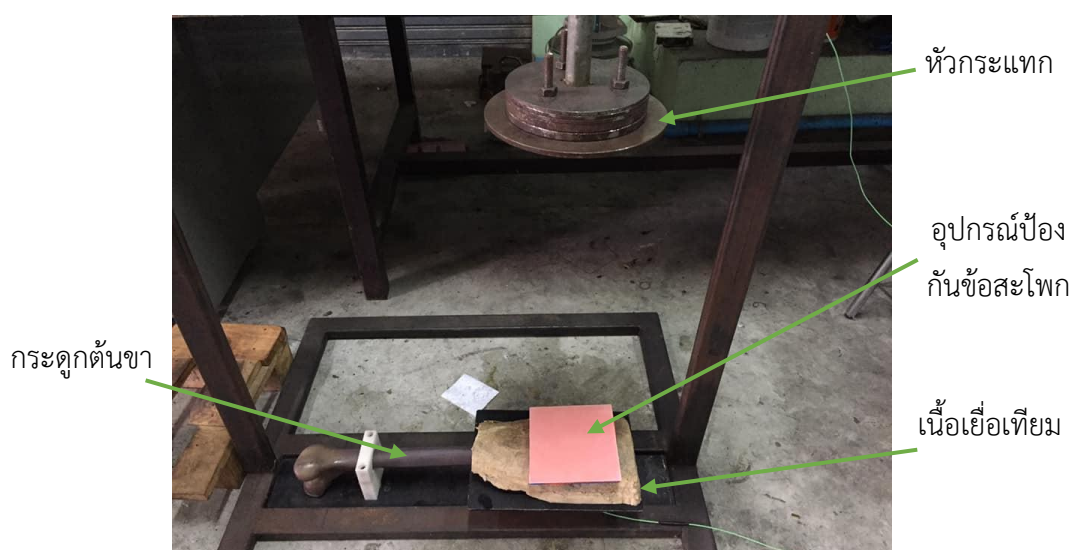
ภาพประกอบ 3.20 การทดสอบตกกระแทกลงบนอุปกรณ์ป้องกันข้อสะโพกโครงสร้างลักษณะแซนด์วิช
