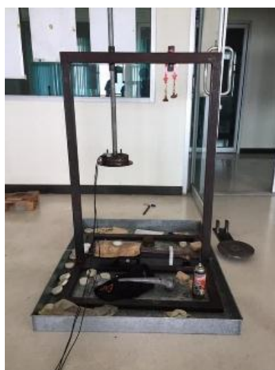
ภาพประกอบ 3.17 ลักษณะโดยรวมของอุปกรณ์ชุดทดสอบการตกกระแทก
