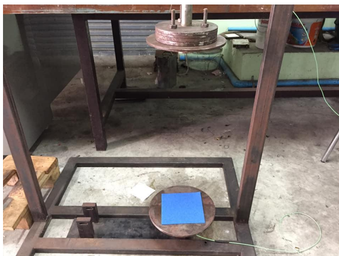
ภาพประกอบ 3.18 การทดสอบตกกระแทกลงบนวัสดุแบบชั้นเดียว
