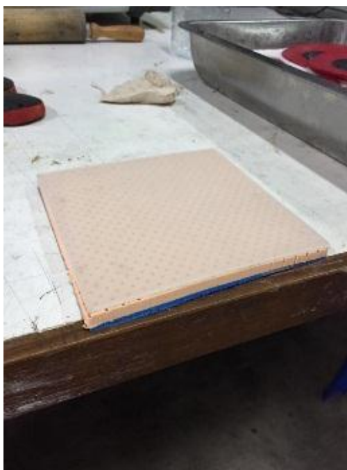
ภาพประกอบ 3.19 ตัวอย่างอุปกรณ์ป้องกันข้อสะโพกโครงสร้างลักษณะแซนด์วิชสำหรับใช้ทดสอบ
