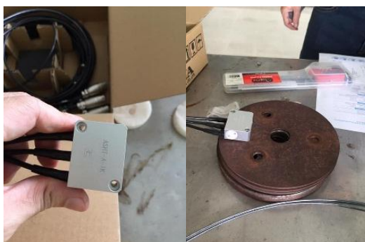
ภาพประกอบ 3.16 อุปกรณ์ตรวจวัดค่าความแข็งสำหรับติดตั้งบริเวณหัวกระแทก
