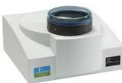
รูปที่ 3-14 เครื่องวิเคราะห์ความเสถียรทางความร้อน (Thermogravimetric analyzer, TGA)
