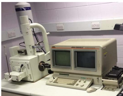
รูปที่ 3-16 กล้องจุลทรรศน์อิเล็กตรอนแบบส่องกราด (Scanning electron microscopy, SEM)
