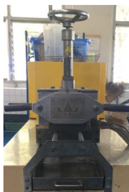
รูปที่ 3-1 เครื่องบดผสมแบบปิด (Internal mixer)
