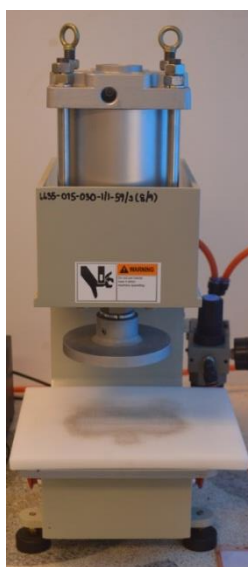
รูปที่ 3-7 เครื่องตัดชิ้นทดสอบแบบควบคุมด้วยลม
