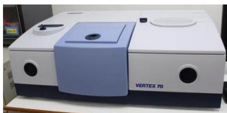
รูปที่ 3-12 เครื่องฟูเรียร์ทรานสฟอร์มอินฟราเรดสเปกโตรสโกปี (Fourier transform infrared spectrometer, FT-IR)
