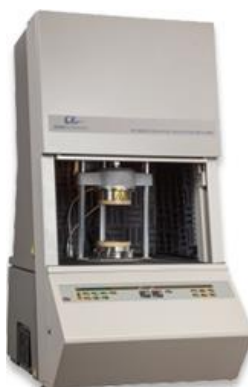
รูปที่ 3-10 เครื่องวัดสมบัติการไหลแบบพลวัต (Rubber process analyzer, RPA)
