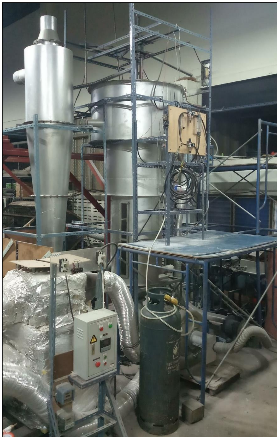
รูปที่ ข.10 ชุดทดลองที่ใช้ในการศึกษาสถานะต่าง ๆ ในกระบวนการอบแห้งแบบพ่นฝอย
