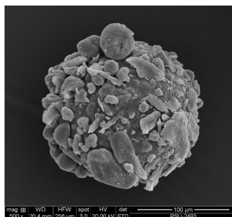
(ข) อนุภาคยางผงกรณี Q_{LPG}=29 l/min V_i=12 m/s และ Q_L=20 g/min
