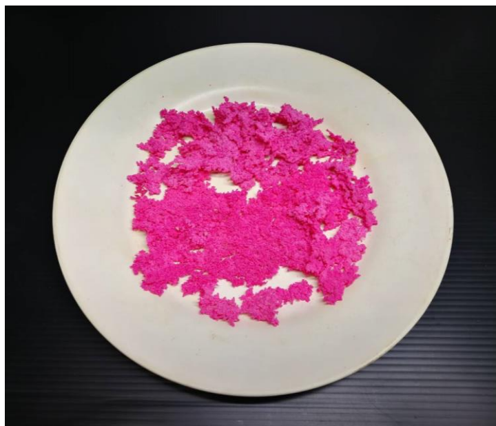
รูปที่ 4.18 ลักษณะของยางที่เตรียมได้ กรณีใช้ผงทัลคัมเคลือบผิวอนุภาคยางธรรมชาติ
