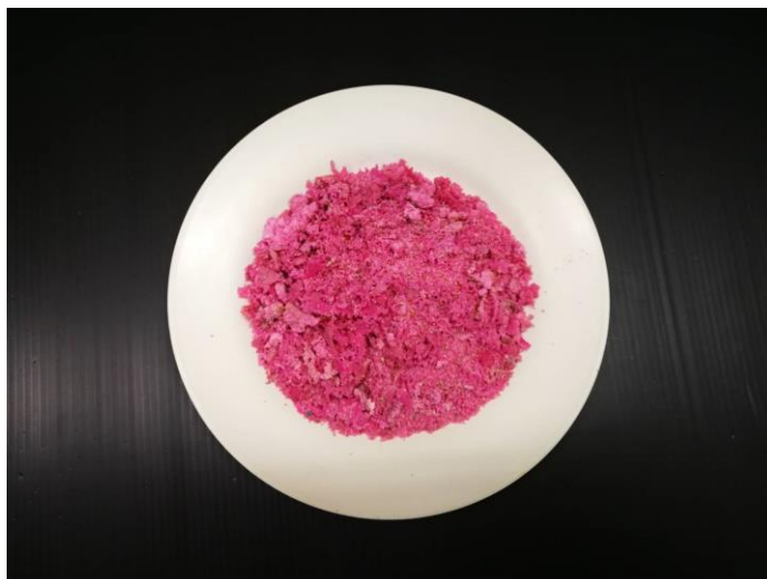
รูปที่ 4.51 ลักษณะของยางที่เตรียมได้ กรณีใช้ซิงค์สเตียเรทเคลือบผิวอนุภาคยางธรรมชาติ ( Q_{Zinc}=50 g/min) Q_{LPG}=29 l/min, V_i=8.7 m/s และ Q_L=20 g/min
