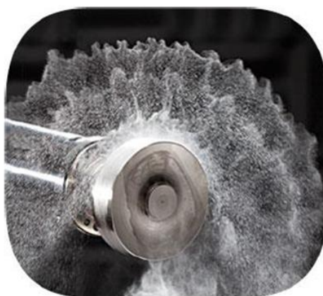
รูปที่ 2.5 การแตกตัวของละอองน้ำด้วยหัวฉีดแบบหมุนเหวี่ยง [4]
