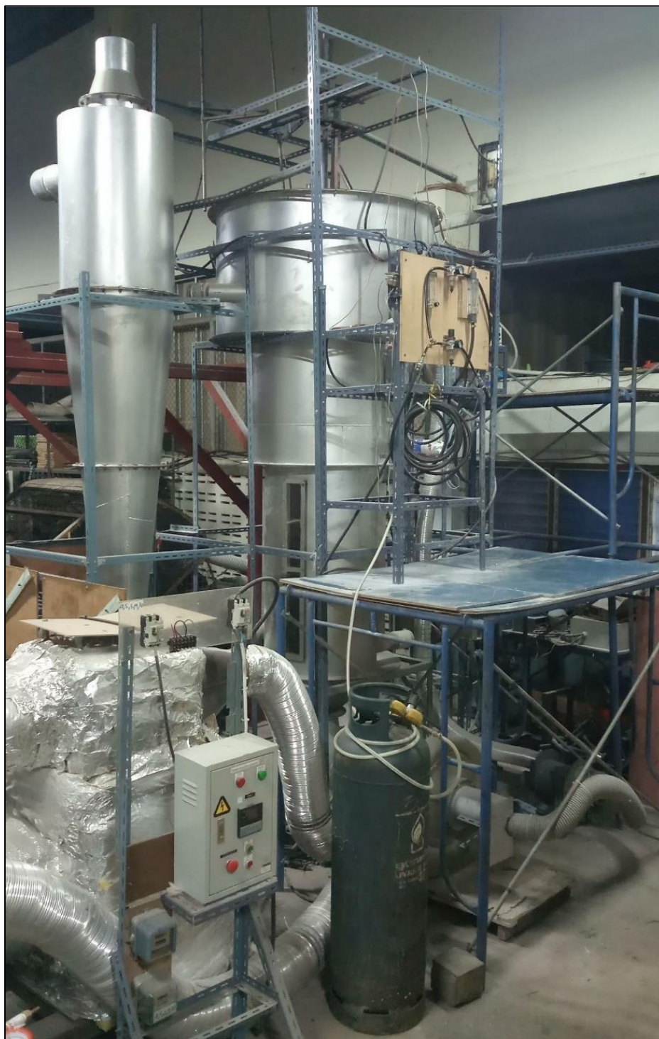
รูปที่ 3.11 ภาพถ่ายชุดทดลองที่ใช้ศึกษาในกระบวนการอบแห้งแบบพ่นฝอย
