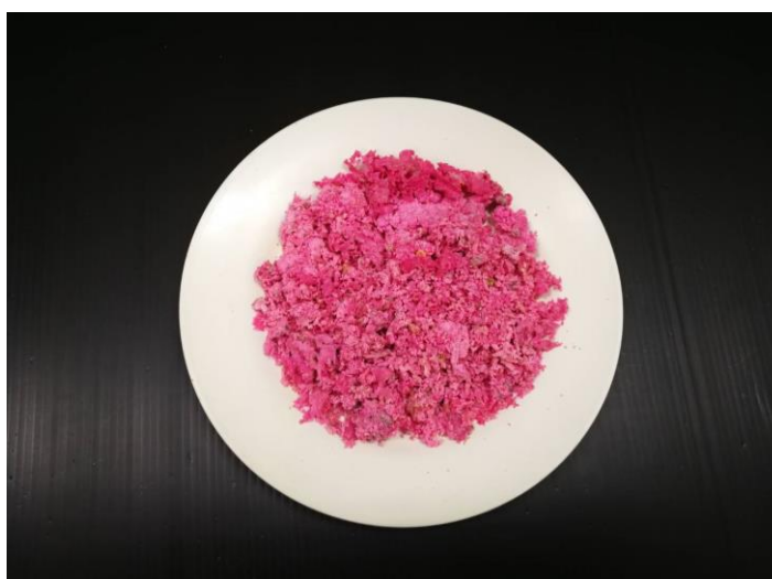
รูปที่ 4.45 ลักษณะของยางที่เตรียมได้ กรณีใช้ซิงค์สเตียเรทเคลือบผิวอนุภาคยางธรรมชาติ ( Q_{Zinc}=50 g/min) Q_{LPG}=29 l/min, V_i=5.5 m/s และ Q_L=40 g/min
