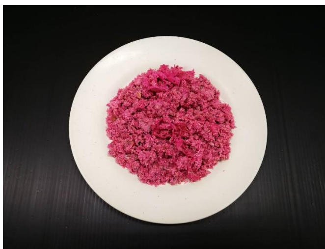
รูปที่ 4.46 ลักษณะของยางที่เตรียมได้ กรณีใช้ผงซิงค์สเตียเรทเคลือบผิวอนุภาคยางธรรมชาติ ( Q_{Zinc}=50 g/min) Q_{LPG}=29 l/min, V_i=5.5 m/s และ Q_L=60 g/min
