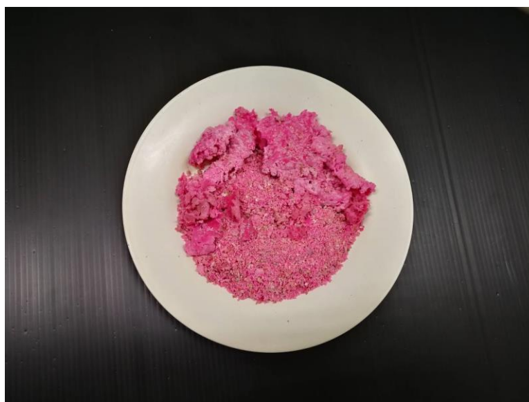
รูปที่ 4.53 ลักษณะของยางที่เตรียมได้ กรณีใช้ซิงค์สเตียเรทเคลือบผิวอนุภาคยางธรรมชาติ ( Q_{Zinc}=50 g/min) Q_{LPG}=29 L/min, V_i=8.7 m/s และ Q_L=60 g/min
