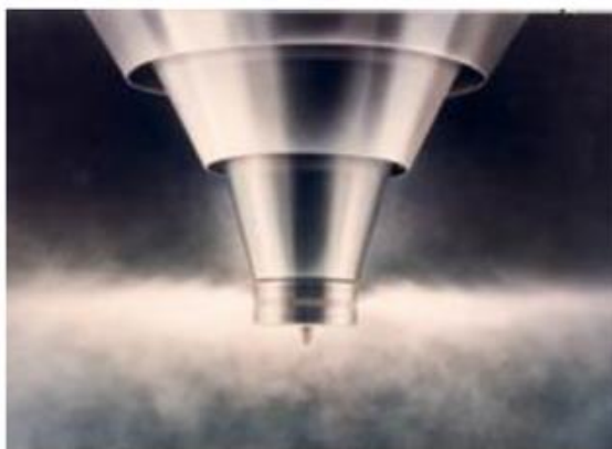
รูปที่ 2.10 หัวฉีดแบบหมุนและลักษณะของละอองฝอย [6]
