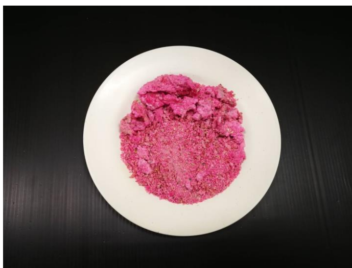
รูปที่ 4.52 ลักษณะของยางที่เตรียมได้ กรณีใช้ซิงค์สเตียเรทเคลือบผิวอนุภาคยางธรรมชาติ ( Q_{Zinc}=50 g/min) Q_{LPG}=29 l/min, V_i=8.7 m/s และ Q_L=40 g/min
