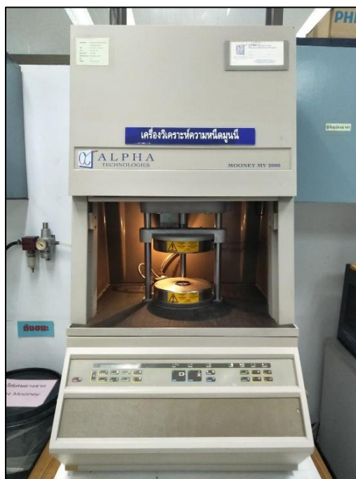
รูปที่ 3.15 เครื่องทดสอบความหนืดของยาง (Rubber Viscosity Tester) รุ่น MV2000
