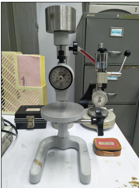
รูปที่ 3.20 เครื่องทดสอบความแข็ง (Hardness tester) รุ่น Digitest II
