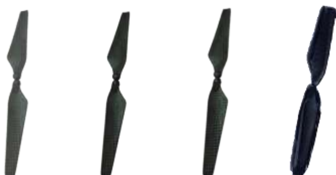
รูปที่ 4.48 ลักษณะของไบพัตโดรนที่ขึ้นรูปได้ (a) CF 1, (b) CF 2, (c) CF 3 และ (d) CF 4 ชั้น
