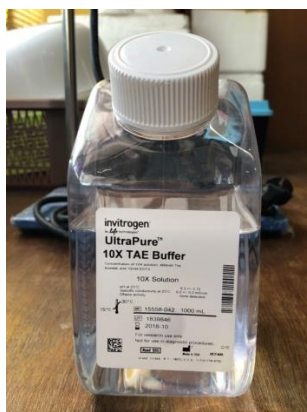
ภาพที่ 16 TAE buffer ใช้เป็นตัวนำไฟฟ้ามีผลต่อการเคลื่อนที่ของดีเอ็นเอ
