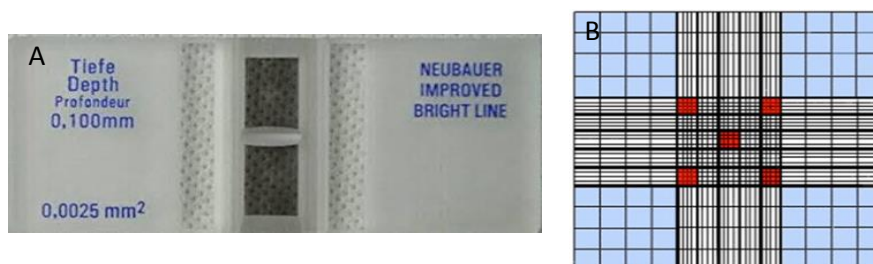
รูปที่ 1 แสดง (A) เครื่องมือนับเซลล์เม็ดเลือด หรือ Hemocytometer, (B) ตำแหน่งที่ทำการนับเซลล์
