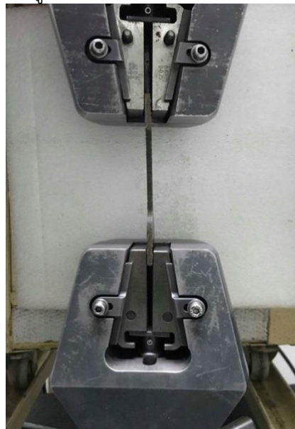
รูปที่ 3.18 การทดสอบความแข็งแรงดึง
