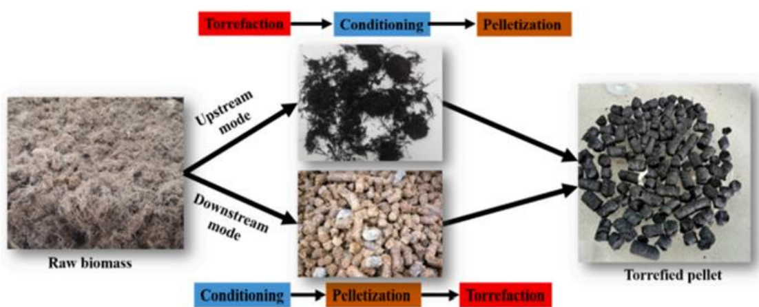
รูปที่ 2.5 กระบวนการก่อนและหลังที่ใช้สำหรับการผลิตชีวมวลทอร์รีแฟคชัน (Yek et al., 2021)
