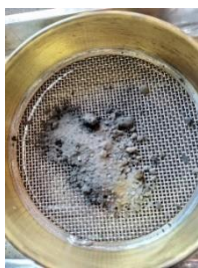
ฉ) ดินฟอกสีใช้แล้วที่ผสม กับถ่านกัมมันต์หลังจาก ผ่านการไพโรไลซิส
