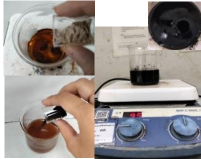
ค) เติมดินฟอกสี ลงไปในน้ำมันปาล์มดิบและปรับอุณหภูมิเป็น 105°C ทำการกวนผสมเป็นเวลา 15 นาที
