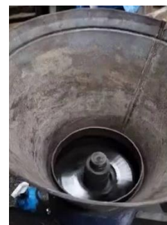
ก-3) เปิดเครื่องอัดเม็ดเชื้อเพลิงและรอให้เครื่องร้อน
