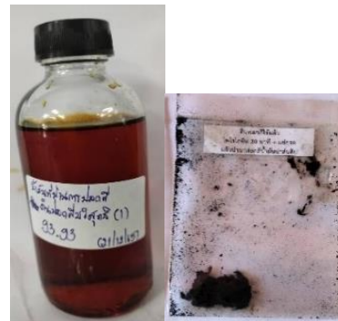
จ) เก็บน้ำมันผ่านการฟอกสีไว้ในขวดและดินฟอกสีที่ผ่านการปรับสภาพและนำมาฟอกสีอีกครั้งในถุงซิปล็อกเพื่อส่งวิเคราะห์
