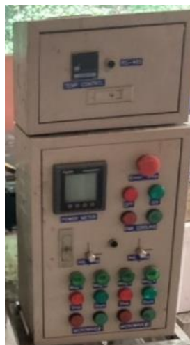
รูปที่ 3.7 ระบบควบคุมความร้อนเตาปฏิกรณ์ไมโครเวฟเทอร์รีแฟคชัน
