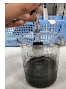
จ) นำดินฟอกสีที่ผ่านการแช่กรดออกมาวัดค่า pH และล้างด้วยน้ำกลั่น
