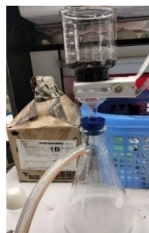
ง) กรองแยกดินฟอกสีออกจากกรดด้วยเครื่องปั๊มสุญญากาศ
