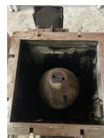
ค) นำขวดดูแรนใส่ในเตาไมโครเวฟเทอร์ริแฟคชัน
