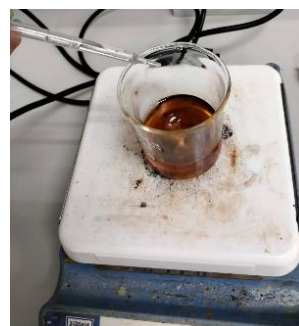
ข) ต้มน้ำมันปาล์มดิบด้วย พร้อมการกวน ที่ 90°C แล้วเติมกรด H_3PO_4 ลงไป 3-5 หยด กวนผสมเป็นเวลา 10 นาที
