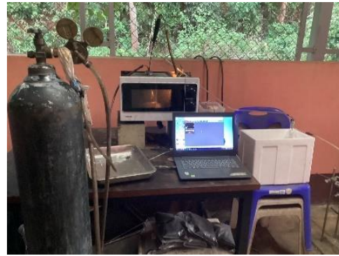
จ) ต่อก๊าซไนโตรเจนเข้าไปในระบบ ต่อบระบบควบคุม อุณหภูมิ และต่อบระบบคอนเดนเซอร์ จากนั้นตั้งอุณหภูมิ และเปิดเครื่องไมโครเวฟแล้วจับเวลาตามที่ต้องการ
