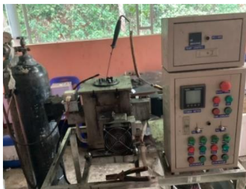
ง) ใส่เทอร์โมคัปเปิ้ล แล้วจึงต่อระบบก๊าซไนโตรเจนและระบบควบคุมความร้อน
