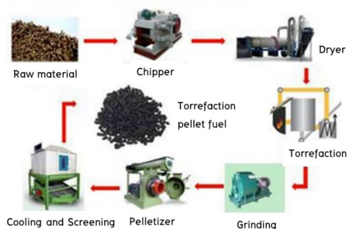
รูปที่ 2.8 กระบวนการผลิตเชื้อเพลิงทอร์รีไฟด์อัดเม็ด (Ungureanu et al., 2016)
