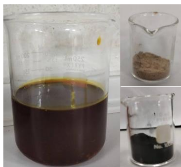
ก) ชั่งน้ำหนักน้ำมันปาล์มดิบ (100g) และดินฟอกสีบริสุทธิ์หรือดินฟอกสีผ่านการไพโรไลซิส หรือดินฟอกสีผ่านการไพโรไลซิสและแช่กรด (1g)
