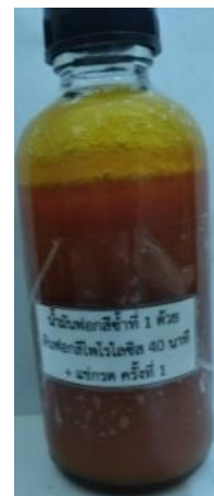
ง-3) น้ำมันที่ผ่านการพอกสีด้วยดินพอกสีใช้แล้วไฟโรไลซิส + แชกรด 40 นาที
