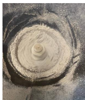
ก-5) นำวัตถุดิบที่ผสมไว้ใส่เข้าไปในเครื่องอัดเม็ดและรอให้เครื่องบีบอัดส่วนผสมจนเป็นเม็ดออกมา
