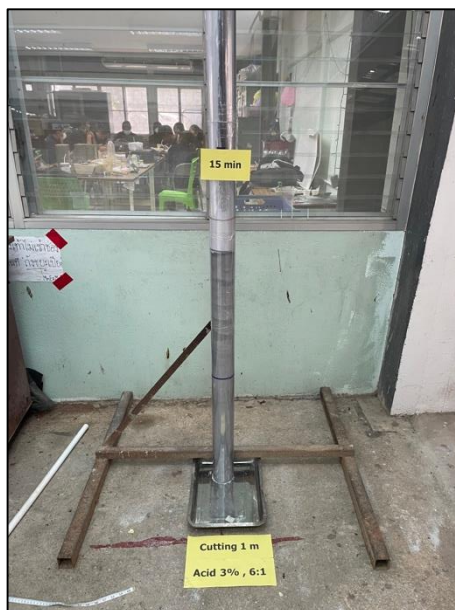
รูปที่ จ 1-5 การทดสอบหาค่าระยะการคายน้ำของน้ำยางพาราสดในอัตราส่วน 6:1 ที่ความเข้มข้นของกรดอะซิติก 3% ที่ระยะ Cutting 1
