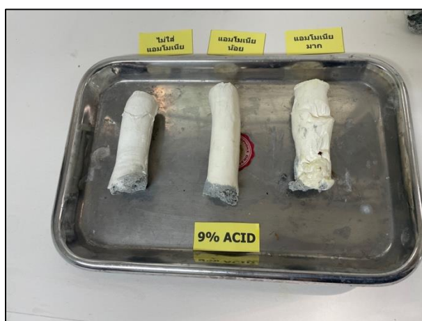
รูปที่ ๑ 1-8 การทดลองการแข็งตัวของน้ำยางพาราสดในอัตราส่วน 10:1 ที่ความเข้มข้นของกรดอะซิติก 9% ภาพที่ 2
