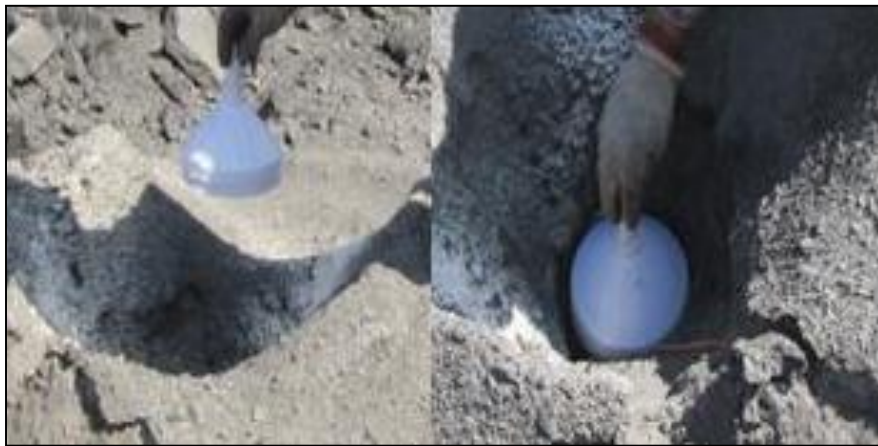
รูปที่ 2.22 การบรรจุกรวยพลาสติกกลับด้านลงหลุมเจาะระเบิด (Bhaskar et al., 2019)
