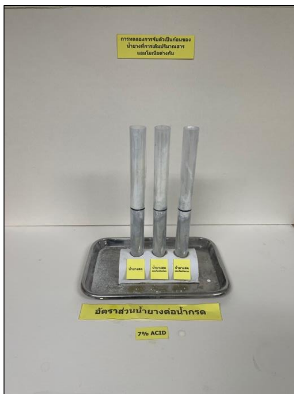
รูปที่ ๑ 1-5 การทดลองการแข็งตัวของน้ำยาด่างพาราสดในอัตราส่วน 10:1 ที่ความเข้มข้นของกรดอะซิติก 7% ภาพที่ 1
