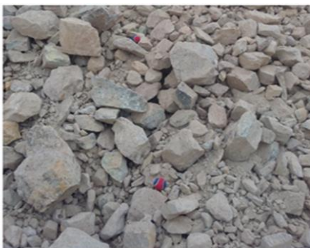
รูปที่ 2.35 ตัวอย่างภาพใช้วิเคราะห์กับซอฟต์แวร์ Split Desktop (Kulula et al., 2017)
