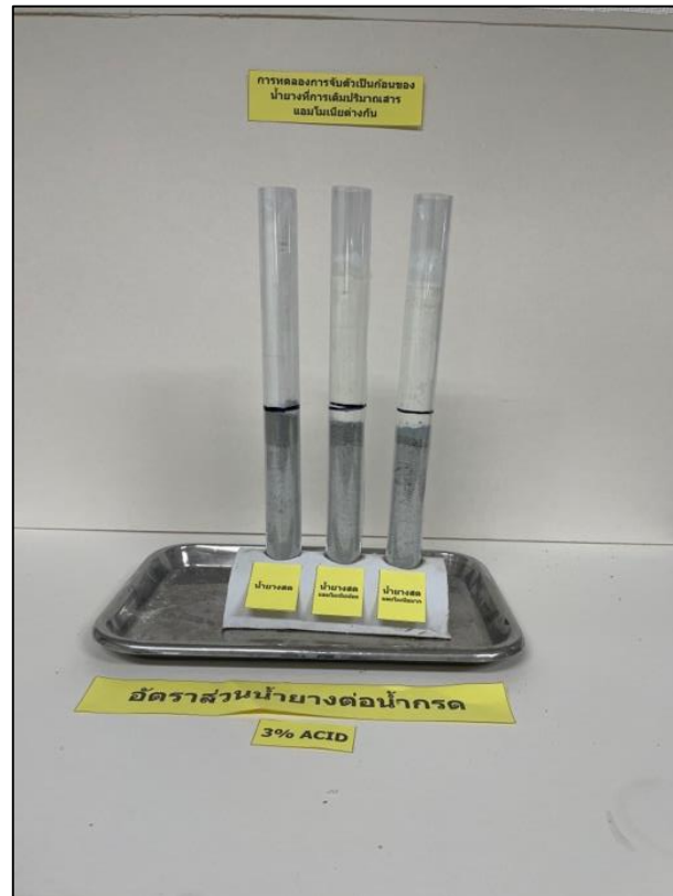
รูปที่ 1-1 การทดลองการแข็งตัวของน้ำยาพาราเซตตามโนเมียมในอัตราส่วน 10:1 ที่ความเข้มข้นของกรดอะซิติก 3% ภาพที่ 1
