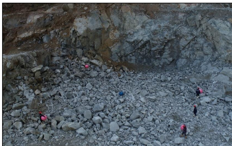
รูปที่ 3.9 วางลูกบอลกระจายให้ทั่วกองหินหลังจากการระเบิด
