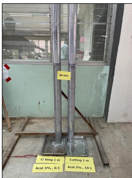
รูปที่ จ 1-6 การทดสอบหาค่าระยะการคายน้ำของน้ำยางพาราสดในอัตราส่วน 10:1 ที่ความเข้มข้นของกรดอะซิติก 3% ที่ระยะ Cutting 1
