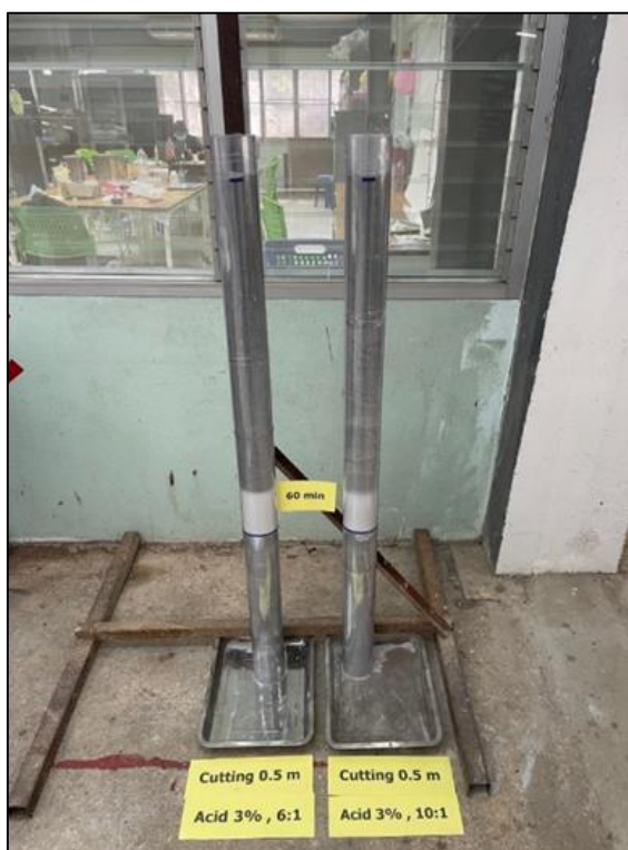
รูปที่ 4.38 การทดสอบหาระยะน้ำที่น้ำยางคายตัวออกมา
