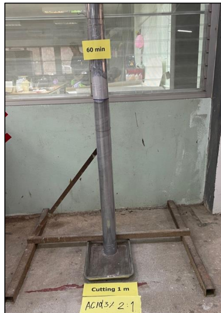
รูปที่ จ 1-4 การทดสอบหาค่าระยะเวลาการคายนํ้าของนํ้ายางพาราสดในอัตราส่วน 2:1 ที่ความเข้มข้นของกรดอะซิติก 3% ที่ระยะ Cutting 1 m
