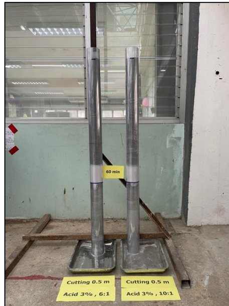
รูปที่ จ 1-3 การทดสอบหาค่าระยะเวลาการคายนํ้าของนํ้ายางพาราสดในอัตราส่วน 10:1 ที่ความเข้มข้นของกรดอะซิติก 3% ที่ระยะ Cutting 0.5 m
