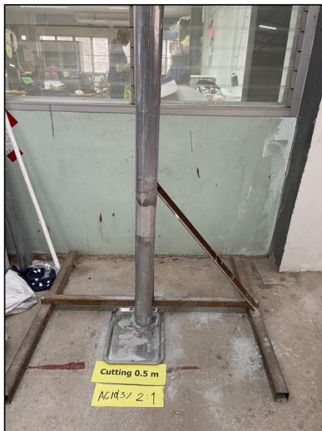
รูปที่ จ 1-1 การทดสอบหาค่าระยะการคายน้ำของน้ำยาฟาราสดในอัตราส่วน 2:1 ที่ความเข้มข้นของกรดอะซิติก 3% ที่ระยะ Cutting 0.5 m
