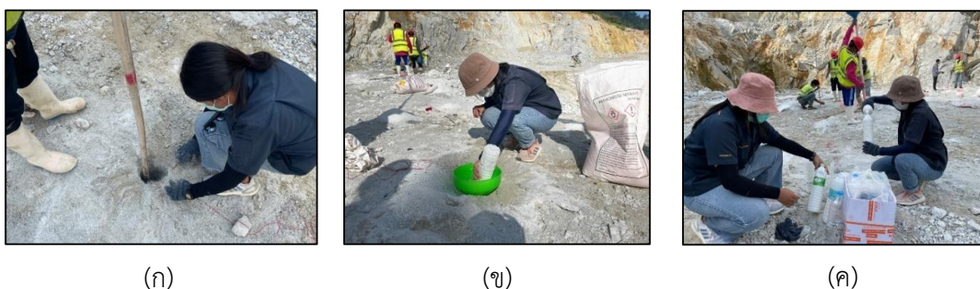
รูปที่ 2.48 วิธีการทดลองการระเบิดจริง (ก) ผสมน้ำยางพาราสดกับกรด, (ข) บรรจุใส่หลุมระเบิด, (ค) วัดการแข็งตัวของน้ำยางพาราสด และปิดหลุมรูระเบิดด้วยเศษหินอีกครั้ง (จิรารวรรณ และสิริรามล, 2564)
