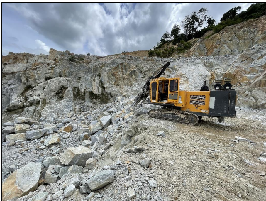
รูปที่ 1.4 เจาระเบิดครั้งที่ 2 หินก้อนโตหลังจากการระเบิด
