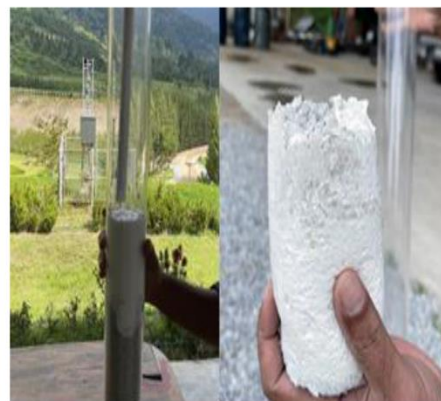
Fig. 7 Stemming plug (natural rubber latex).
