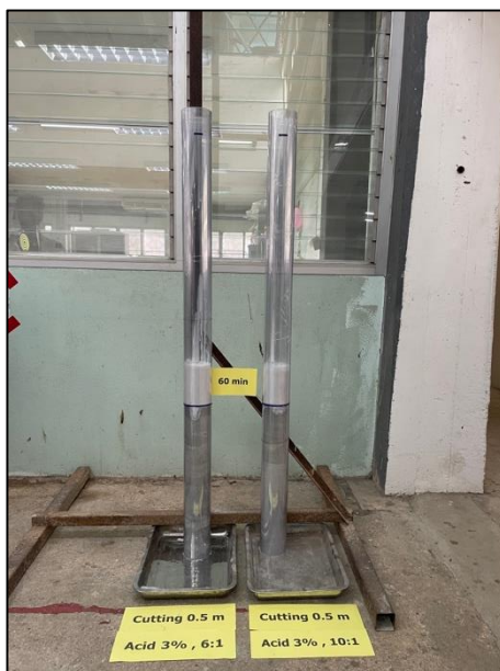
รูปที่ จ 1-2 การทดสอบหาค่าระยะการคายน้ำของน้ำยาฟาราสดในอัตราส่วน 6:1 ที่ความเข้มข้นของกรดอะซิติก 3% ที่ระยะ Cutting 0.5 m
