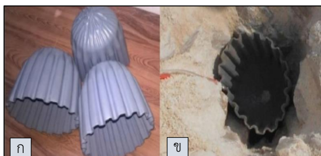
รูปที่ 2.17 Stemming Plug ครั้งที่ 1 (ก) แบบพลาสติก (ข) การบรรจุในหลุมเจาะ (Ur Rehmen et al., 2021)
