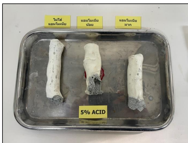
รูปที่ 1-4 การทดลองการแข็งตัวของน้ำยาพาราสดในอัตราส่วน 10:1 ที่ความเข้มข้นของกรดอะซิติก 5% ภาพที่ 2
