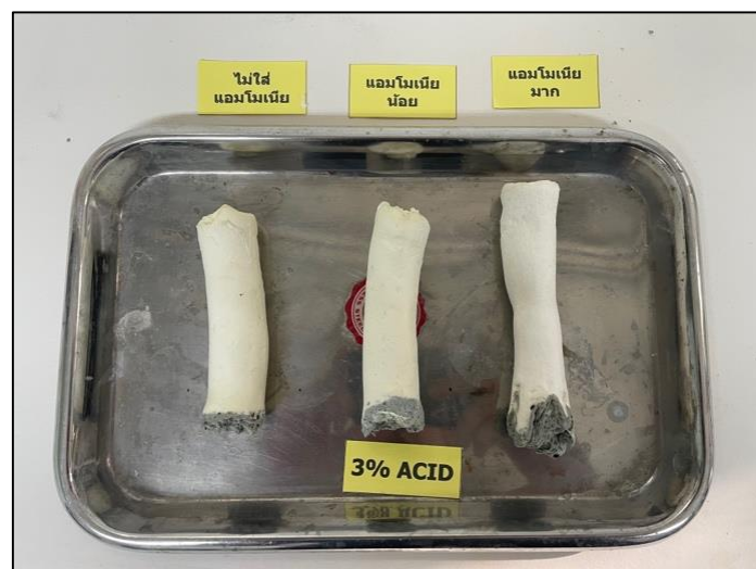
รูปที่ 1-2 การทดลองการแข็งตัวของน้ำยาพาราเซตตามโนเมียมในอัตราส่วน 10:1 ที่ความเข้มข้นของกรดอะซิติก 3% ภาพที่ 2
