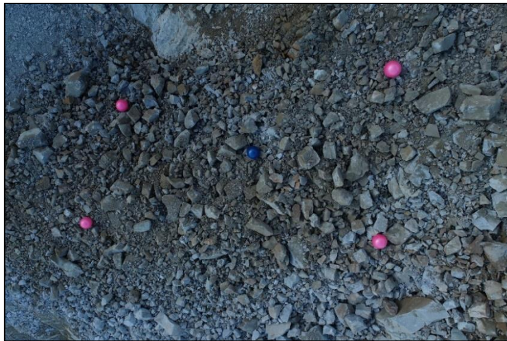
รูปที่ 3.10 ภาพถ่ายการกระจายตัวของหินด้วยอากาศยานไร้คนขับ
