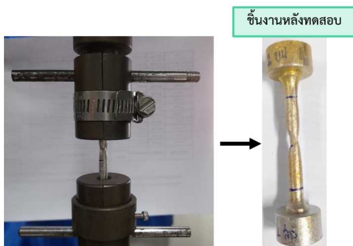
รูปที่ 3.7 ชิ้นงานหลังจากการทดสอบความต้านทานแรงดึง
