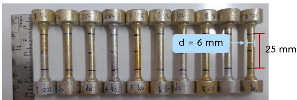
รูปที่ 3.6 ระยะทดสอบและเส้นผ่านศูนย์กลางของชิ้นงานทดสอบ
