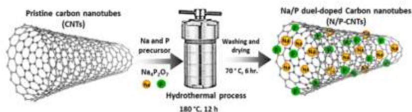
รูปที่ 5. แสดงการสังเคราะห์วัสดุนาโนคาร์บอนที่เจือด้วยโซเดียมและฟอสฟอรัส
