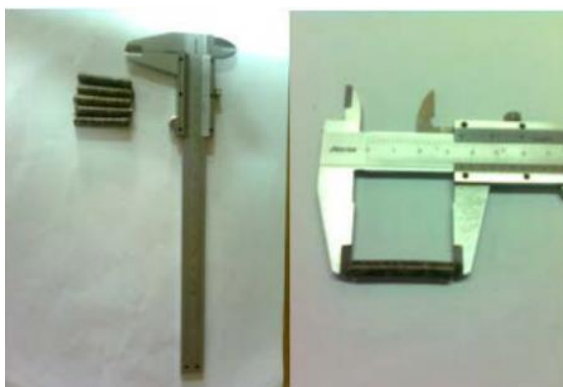
รูปที่ 3.13 การวัดความยาวของเม็ดเชื้อเพลิงชีวมวล
