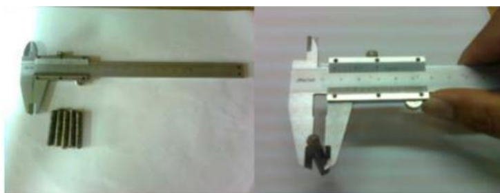
รูปที่ 3.12 การวัดความยาวของเม็ดเชื้อเพลิงชีวมวล
