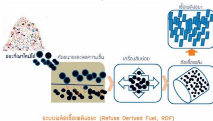
รูปที่ 2.5 ระบบผลิตเชื้อเพลิงขยะ (Refuse Derived Fuel, RDF)
