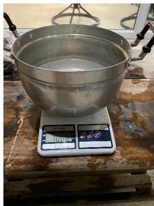
รูปที่ 3.16 เติมน้ำลงในหม้อสแตนเลส ปริมาณน้ำ 1,000 g
