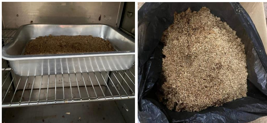
รูปที่ 3.2 กระบวนการอบขี้เลื่อยไม้ยางพาราที่อุณหภูมิ 103 °c เพื่อให้มีความชื้น 12% -15%
