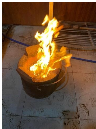
รูปที่ 3.18 ใส่เม็ดเชื้อเพลิงชีวมวลตรงกลางของเตาแล้วจุดไฟทิ้งไว้ 5 นาที
