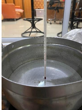
รูปที่ 3.17 ใช้เทอร์โมมิเตอร์วัดอุณหภูมิเริ่มต้นของน้ำ
