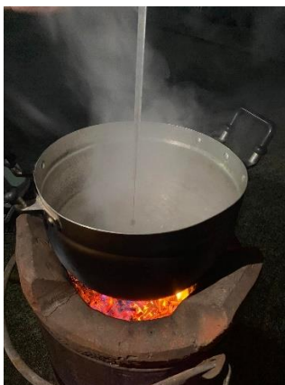
รูปที่ 3.19 ใช้เทอร์โมมิเตอร์วัดอุณหภูมิทุกๆ 5 นาที จนกระทั่งน้ำเดือดที่ 98 °C
