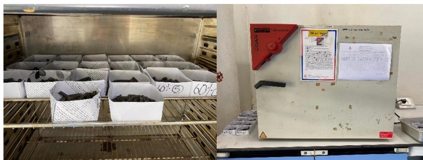
รูปที่ 3.14 การอบหาค่าความชื้นของเม็ดเชื้อเพลิงชีวมวล
