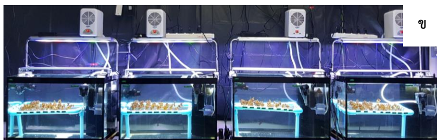
ภาพที่ 10 แสดง ก. การวางชิ้นส่วนปะการังในตู้ทดลองขนาด 70 ลิตร โดยมีชิ้นส่วนปะการังจากทั้งสองพื้นที่ศึกษา ข. การวางชิ้นส่วนปะการังในแต่ละตู้ทดลองที่มีสภาวะของอุณหภูมิและความเข้มแสงที่แตกต่างกัน
