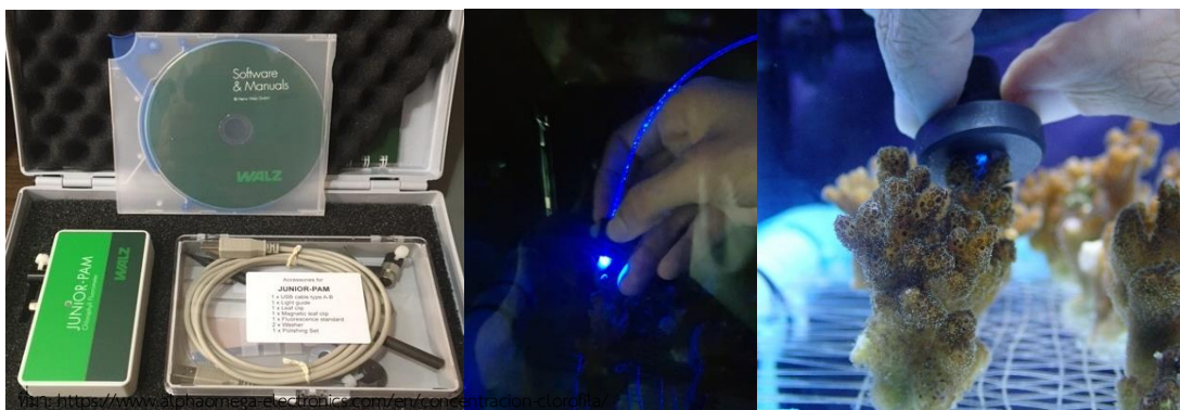
ภาพที่ 14 แสดงวัดประสิทธิภาพการสังเคราะห์ด้วยแสงด้วยอุปกรณ์ Pulse Amplitude Modulated (PAM) Fluorometry (Walz, Germany) ที่เชื่อมต่อกับคอมพิวเตอร์ร่วมกับโปรแกรม WinControl
