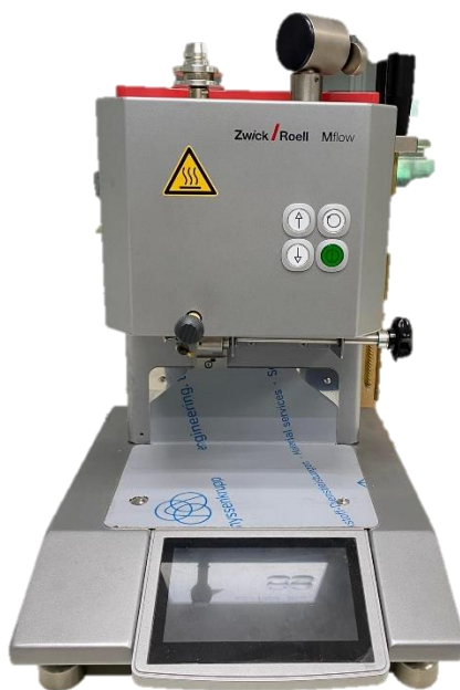
รูปที่ 3.8 เครื่องทดสอบดัดขึ้นรูปการหลอมไหลของพอลิเมอร์
