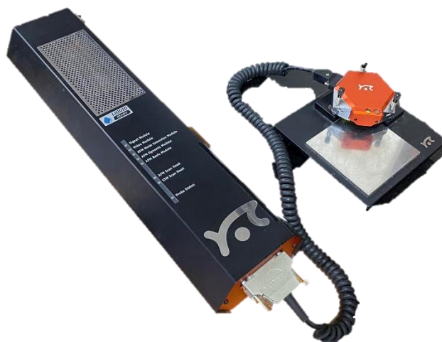
รูปที่ 3.16 เครื่องวิเคราะห์ลักษณะทางสัณฐานวิทยาด้วยกล้องจุลทรรศน์แรงอะตอม
