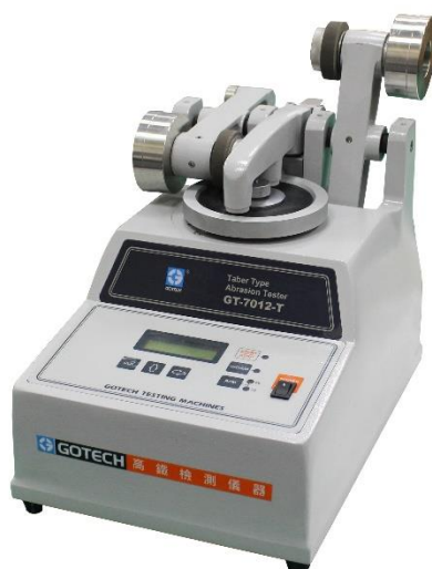
รูปที่ 3.13 เครื่องทดสอบความต้านทานต่อการสึกหรอแบบ Taber
