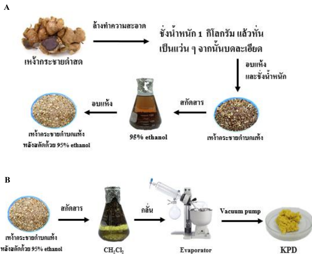
รูปที่ 14: แสดงขั้นตอนการเตรียมสารสกัดจากเหง้ากระชายดำด้วยไดคลอโรมีเทน ขั้นตอนที่ 1 (A) และขั้นตอนที่ 2 (B)
