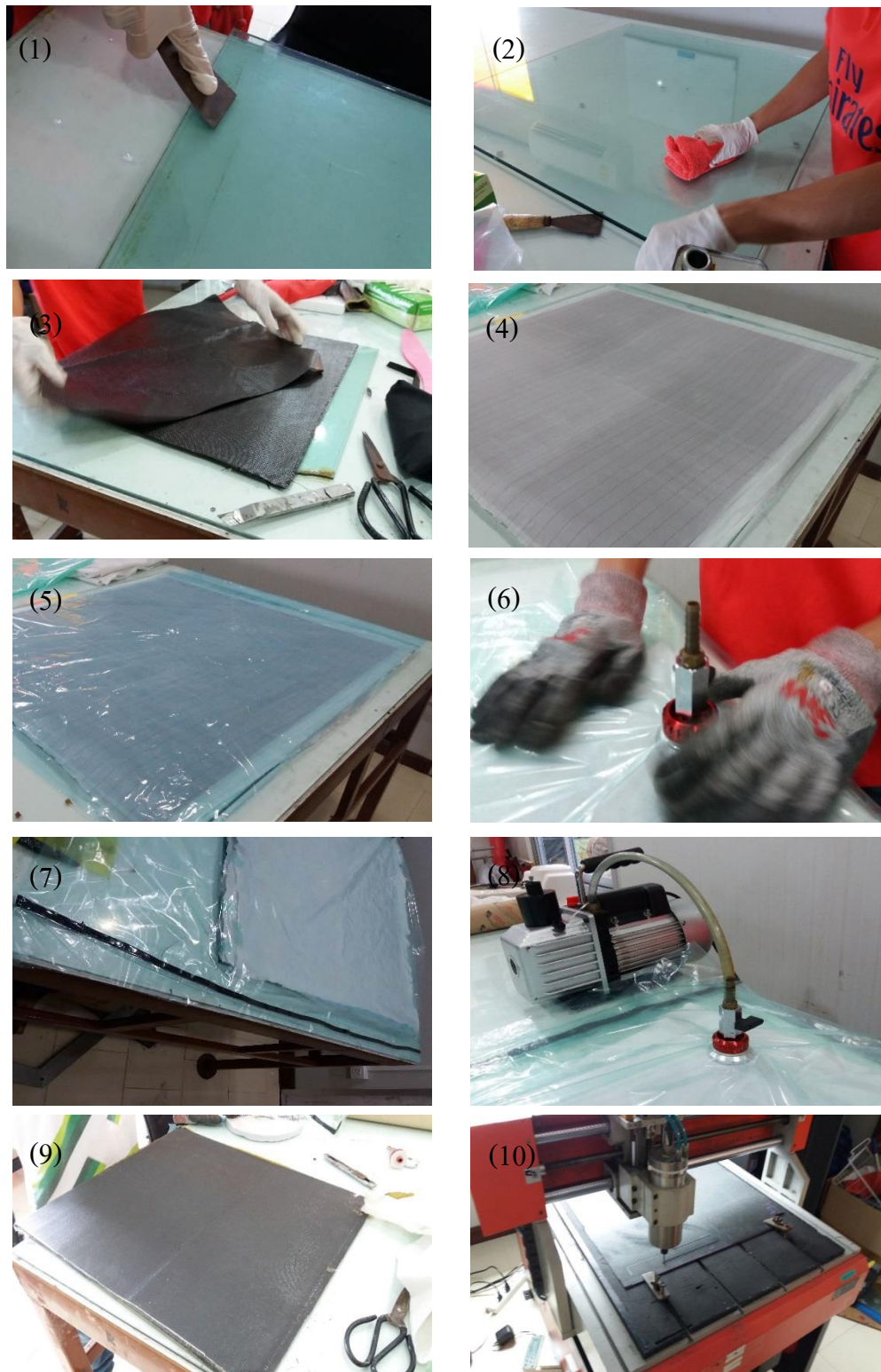
รูปที่ 3.7 ขั้นตอนการขึ้นรูปชิ้นงานคอมโพสิต UAV
