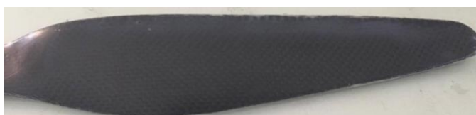
(e) ใบพัด UAV ผสมนาโนซิลิกา 4 phr
