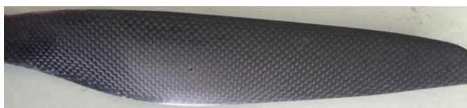
(b) ใบพัด UAV ผสมนาโนซิลิกา 1 phr
