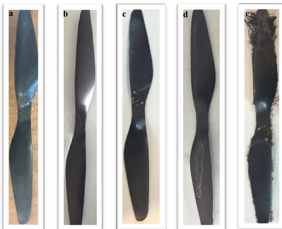
รูปที่ 4.20 ใบพัดอากาศยานไร้คนขับที่มีการแปรปริมาณจำนวนชั้นของแผ่นคาร์บอนไฟเบอร์ (a) 1 ชั้น (b) 2 ชั้น (c) 3 ชั้น (d) 4 ชั้นและ (e) 5 ชั้น
