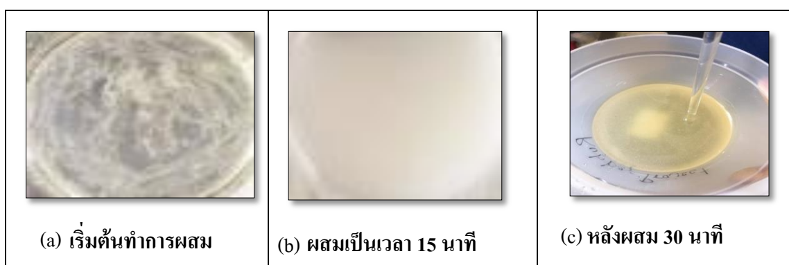
ตารางที่ 4.7 ลักษณะทางกายภาพของอิพ็อกซีเรซินผสมยาง ENR 50 นาโนซิลิกาและสารคงรูปต่อระยะเวลาการผสม
