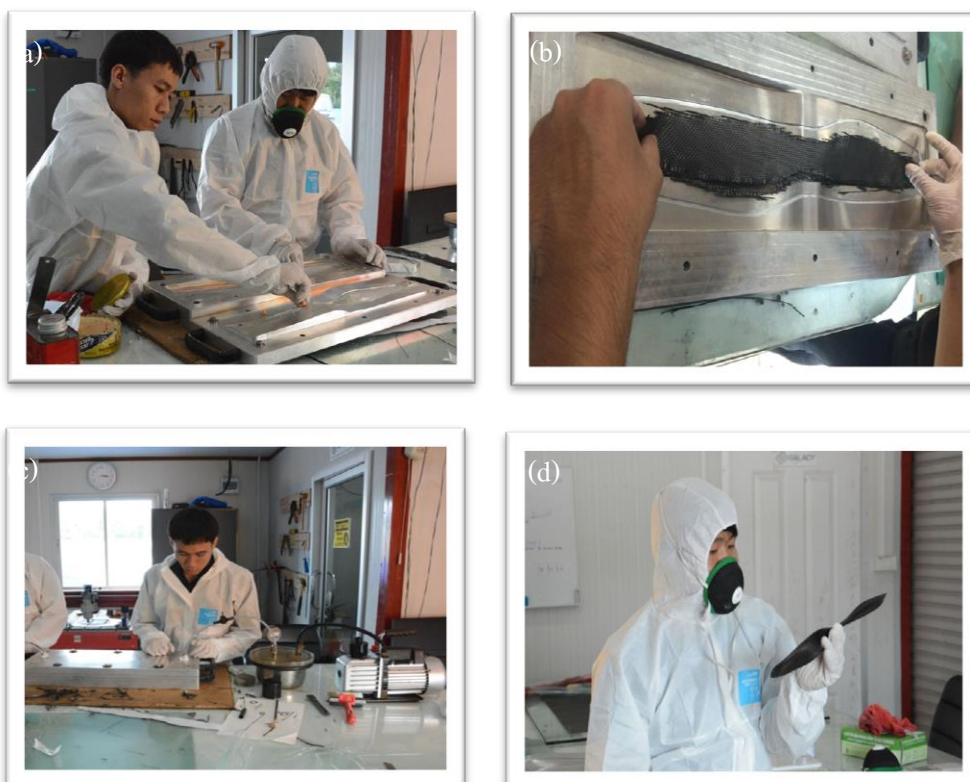
รูปที่ 4.19 การขึ้นรูปไบโพลีเมอร์จากพืชอากาศยานไร้คนขับแบบ Infusion จากแบบพิมพ์เหล็ก
