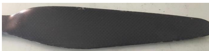
(d) ใบพัด UAV ผสมนาโนซิลิกา 3 phr
