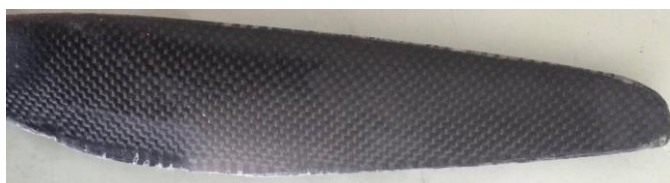
(c) ใบพัด UAV ผสมนาโนซิลิกา 2 phr
