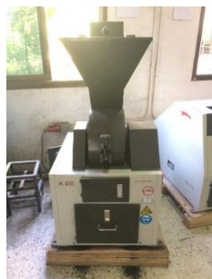
(ข) เครื่องบดแบบค้อนเหวี่ยง (Hammer Crusher)
