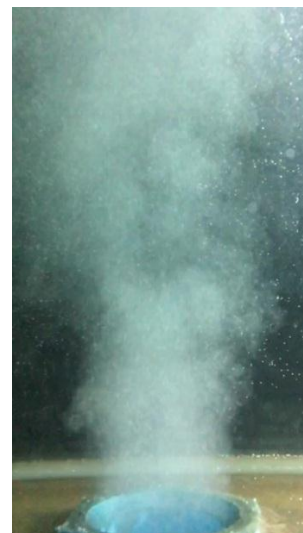
(ค) หัวฉีดแบบอีเจ็คเตอร์คู่ กับถังความดัน
