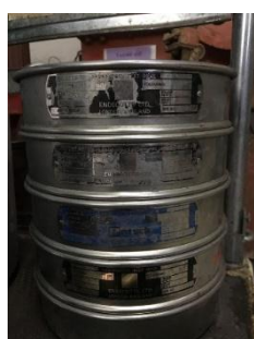
(ง) ตะแกรงคัดขนาดแบบมาตรฐาน (Standard Sieve)
