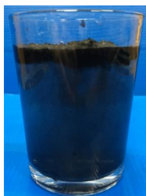
(ค) ถ่านหินที่ผ่านการปรับสภาพลอยในน้ำที่มีฟองอากาศขนาดใหญ่
