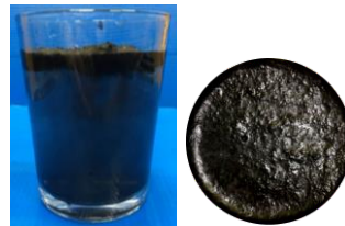
(ค) ถ่านหินที่ผ่านการปรับสภาพลอยใต้น้ำที่มีฟองอากาศขนาดเล็ก
