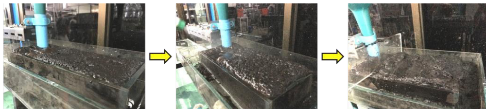
(ก) หัวแร่ที่ลอยขึ้นมากับฟองอากาศ (ข) การสเปรย์น้ำบนหัวแร่เพื่อชะล้างมลทิน (ค) กวาดหัวแร่ใส่ภาชนะ
