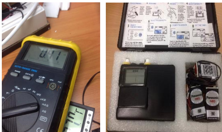
รูปที่ 3.1 เครื่องกระตุ้นด้วยกระแสไฟฟ้าโดยสามารถวัดค่ากระแสได้ในช่วง 1-100 \mu\text{A}
