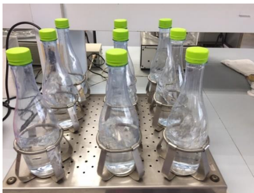
ภาพที่ 2-2 เตรียมตัวอย่างน้ำชะด้วยเครื่องเขย่า (shaker)
