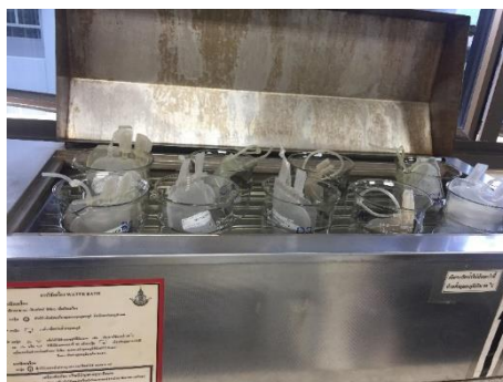
ภาพที่ ช-13 การสกัดตัวอย่างน้ำชะจากถุงเลือด
