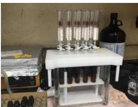
รูปที่ 2.4 การกำจัดสารปนเปื้อนด้วยเครื่อง SPE manifold
