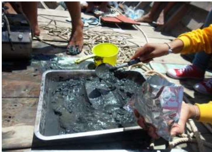
รูปที่ 3.4 เก็บตัวอย่างตะกอนดินใส่อะลูมิเนียมฟอยล์
