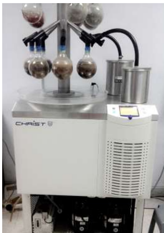
รูปที่ 3.5 การทำตัวอย่างตะกอนดินให้แห้งด้วยวิธี freeze dry
