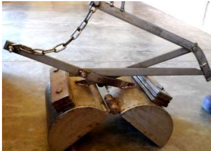
รูปที่ 3.3 อุปกรณ์เก็บตะกอนดิน (van Veen grab Sampler)
