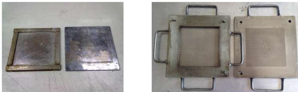
รูปที่ 3.6 ลักษณะเบ้าขึ้นรูปชิ้นตัวอย่าง ด้านซ้ายหนา 0.2 cm และด้านขวาหนา 0.9 cm
