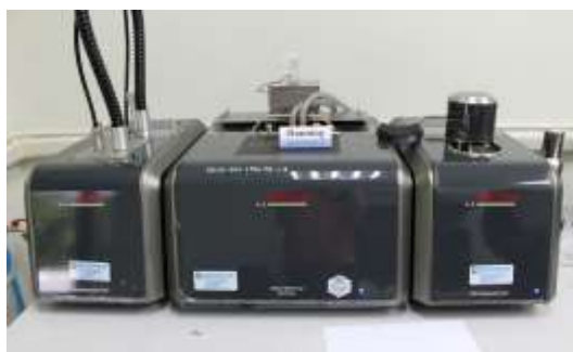
รูปที่ 3.10 เครื่องวัดขนาดอนุภาค (Laser Particle Size Analyzer)
