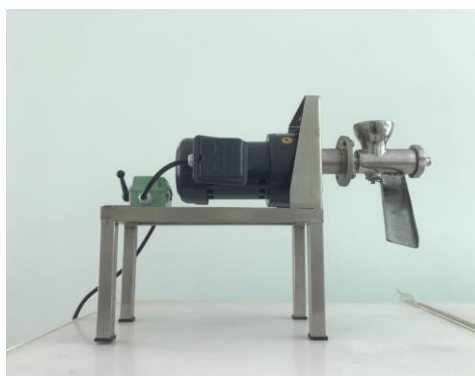
ภาพที่ 10 เครื่องบีบสกัดน้ำมันแบบสกรูเพลส
