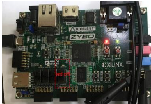
(b) จำนวนบิตที่ส่งยังไม่ครบ 1Gbit led off
