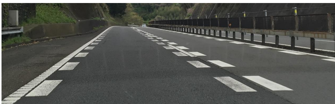
รูปที่ 2-34 ตัวอย่างแถบชะลอความเร็วตามขวางแบบ Optical speed bar
