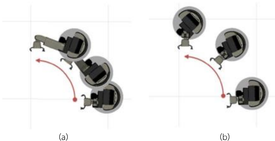
รูปที่ 3-18 แสดงผลลัพธ์ของการวางแผนวิถีการเคลื่อน (a) การทำงานส่วนปลายไปตามเส้นตรง หรือ (b) วิธีที่จะเคลื่อนที่ไปตามเส้นโค้งวงกลม โดยกำหนดองศาอิสระของฐาน HSR [17]
