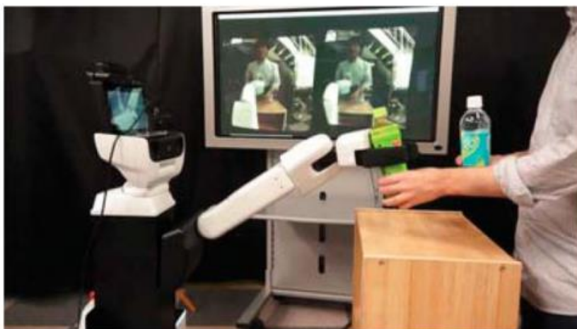
รูปที่ 2-10 แสดงถึงลักษณะการทำงานของหุ่นยนต์ทำงานร่วมกับมนุษย์ [14]
