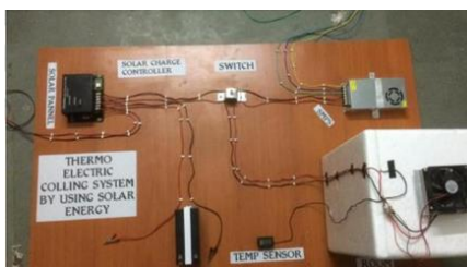
รูปที่ 2.31 ชุดทดลองระบบทำความเย็นด้วยเทอร์โมอิเล็กทริก (Patel et al., 2019)
