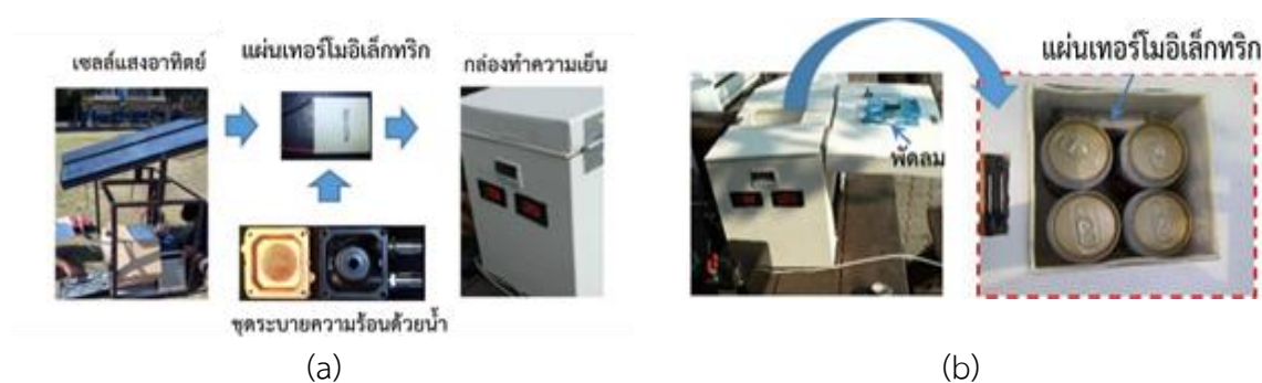
รูปที่ 2.40 (a) ชุดทดสอบสมรรถนะการทำงานของระบบทำความเย็นด้วยเทอร์โมอิเล็กทริกที่ใช้พลังงานไฟฟ้าจากเซลล์แสงอาทิตย์ (b) โครงสร้างภายในกล่องทำความเย็นเทอร์โมอิเล็กทริก (กิตติ, 2558)
