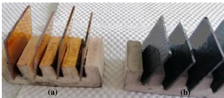
รูปที่ 3.33 กระจกสไลด์บนที่วางเซรามิกส์ (a) กระจกสไลด์ก่อนเผาผนึก และ (b) หลังเผาผนึกแล้ว
