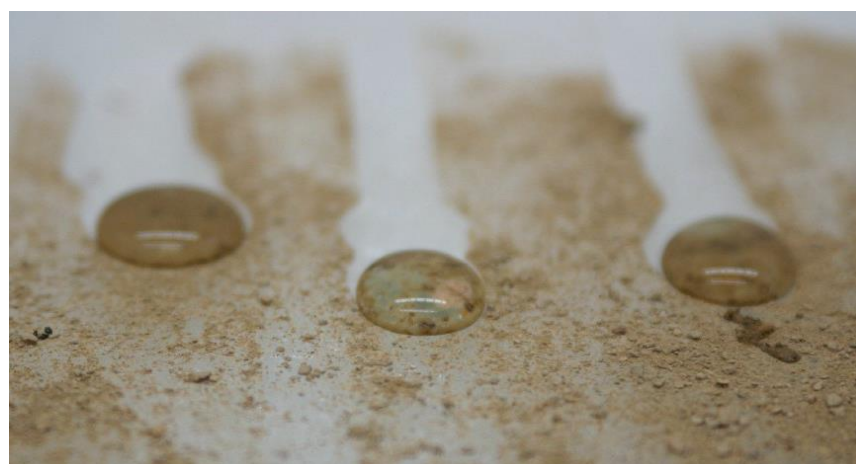
รูปที่ 2.17 การทำความสะอาดตัวเองของกระจกแบบไม่ชอบน้ำ [30]
