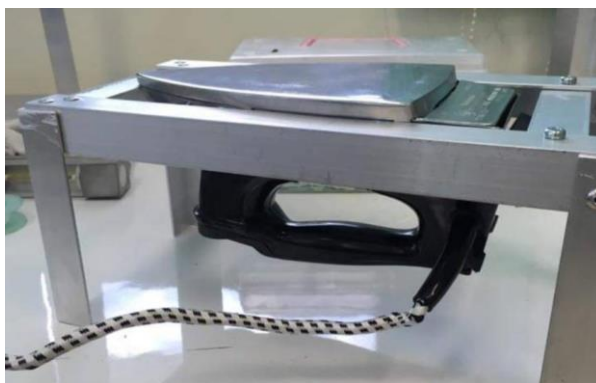
รูปที่ 3.38 การวิเคราะห์ด้วยเทคนิค Four Point Probe โดยใช้ตัวทำความร้อนจากเตารีด
