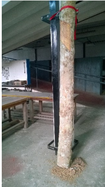
ภาพที่ 3.3 การจับยึดต้นยางพาราก่อนทำการกรีด
