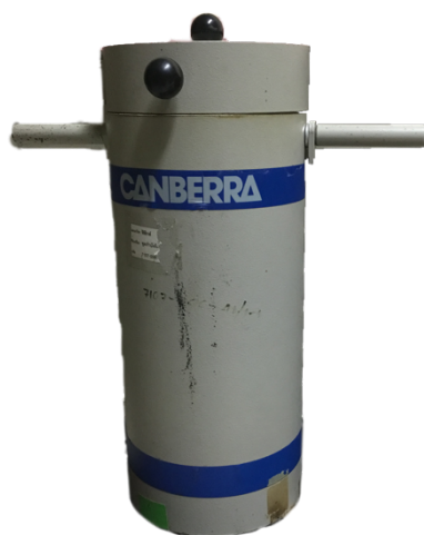
รูปที่ 2.17 เครื่องแกมมาสเปกโตรมิเตอร์ระบบหัววัด NaI (TL)
