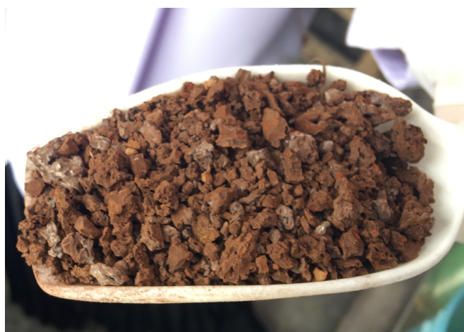
รูปที่ 3.2 กากตะกอนเหล็กจากบ่อบำบัดน้ำเสียของโรงงาน
