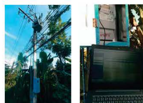
(a) การติดตั้งมิเตอร์สำหรับวัดกระแส (b) การดึงข้อมูลจากมิเตอร์ รูปที่ 1 การวัดค่ากระแส โหลด ภาวะกระแสไม่สมดุล ด้วยการติดตั้งมิเตอร์
