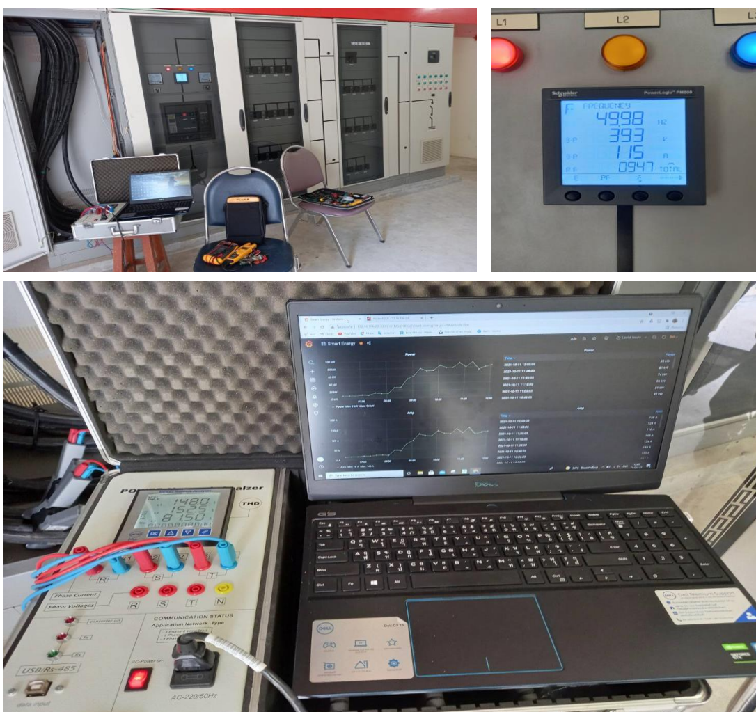
ภาพที่ 50 เปรียบเทียบผลการวัดของระบบตรวจวัดการใช้พลังงานไฟฟ้าด้วยโปรแกรมที่พัฒนาขึ้น กับผลการวัดจาก Multi-Function Digital Power Meter
