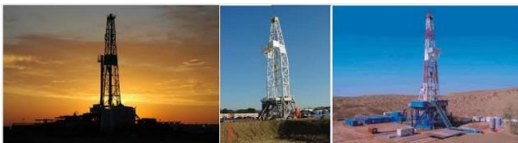
ภาพที่ 2.6 แท่นบกหรือแลนด์ริก (land rig)
