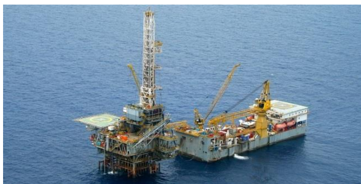
ภาพที่ 2.7 แท่นเจาะแบบเทนเดอร์บาร์จ (tender barge)
