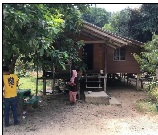
ภาพประกอบที่ 44 : การปรับตัวโครงสร้างบ้านเรือนแบบใต้ถุนยกสูงของประชาชนในพื้นที่หมู่ที่ 5 บ้านหลังเขา เพื่อรับมือกับอุทกภัย
