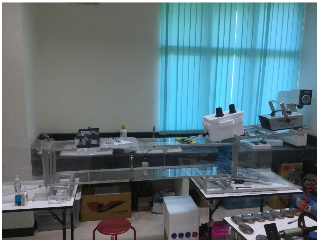
รูปที่ 3-28 อุโมงค์ลมที่จะใช้ทดสอบการทำงานของกังหันลม
