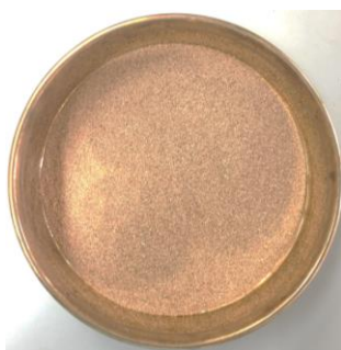
รูปที่ 3.1 ขี้เลื่อยไม้ยางพาราที่ได้จากการคัดขนาดด้วยตะแกรงมาตรฐานเบอร์ 70
