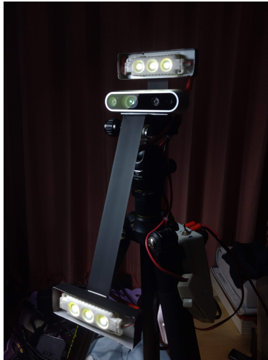
รูปที่ 2.57: อุปกรณ์ถ่ายภาพแนวรอยกรีตระยะใกล้
