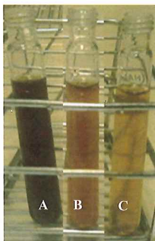
รูปที่ 3.12 สีของน้ำทิ้งโรงงานสกัดน้ำมันปาล์มก่อนบำบัด (A), ผ่านการบำบัดโดยดิน (B) และดินที่ปลูกหญ้า (C)
