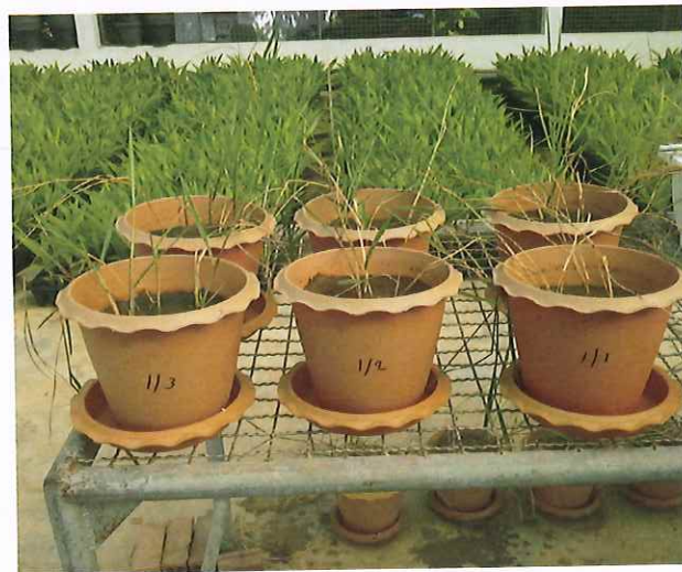
รูปที่ 2.8 ชุดการทดลองที่มีการปลูกหญ้าในกระถางและวางบนภาชนะรองกระถางเพื่อเก็บตัวอย่างน้ำชะในการทดสอบประสิทธิภาพการบำบัดสารประกอบฟีนอลิกและสีภายใต้โรงเรือนเพาะปลูก
