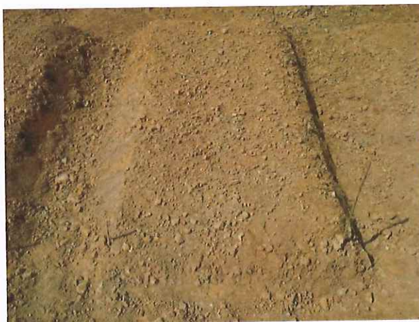
รูปที่ 2.9 การเตรียมแปลงทดลองขนาด 1 x 2 ตารางเมตร บริเวณพื้นที่ของ โรงงานสกัดน้ำมันปาล์ม
