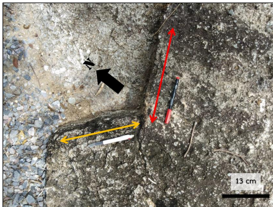
ภาพประกอบ 3.14 รอยแยกบนหินแกรนิตที่มีทิศทางการวางตัวของแนวระนาบจากทิศตะวันตกเฉียงเหนือ - ทิศตะวันออกเฉียงใต้ (NW-SE) และทิศทางการวางตัวของแนวระนาบในทิศทางตะวันออกเฉียงเหนือ - ทิศตะวันตกเฉียงใต้ (NE-SW)
