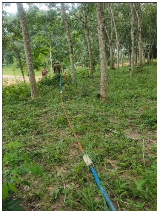
ภาพประกอบ 3.41 การเดินเก็บข้อมูลด้วยเครื่องมือเรดาร์หยั่งลึกในแนวสำรวจที่ 2
