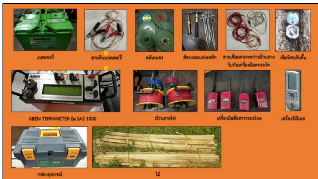
ภาพประกอบ 2.36 แสดงอุปกรณ์การสำรวจด้วยวิธีการวัดค่าสภาพต้านทานไฟฟ้าแบบอะซิมูท
