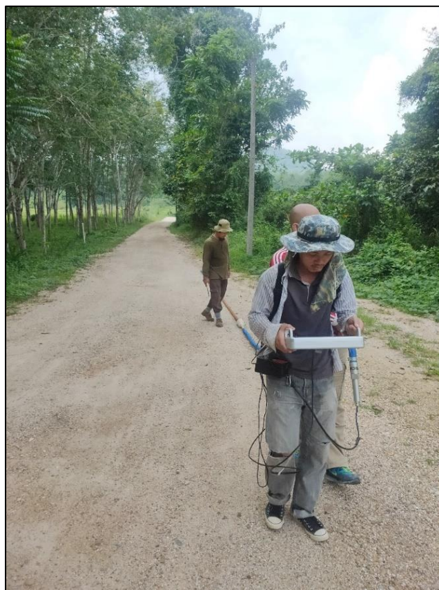
ภาพประกอบ 3.34 การเก็บข้อมูลด้วยเครื่องมือเรดาร์หยั่งลึกในแนวสำรวจที่ 1
