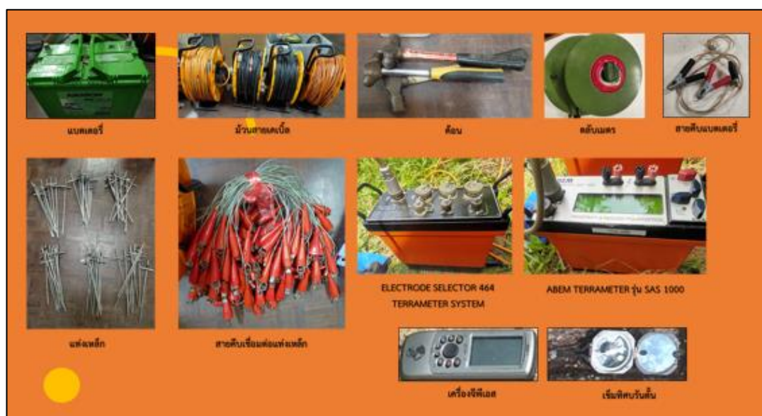
ภาพประกอบ 2.37 แสดงอุปกรณ์การสำรวจด้วยวิธีการวัดค่าสภาพต้านทานไฟฟ้าแบบ 2 มิติ
