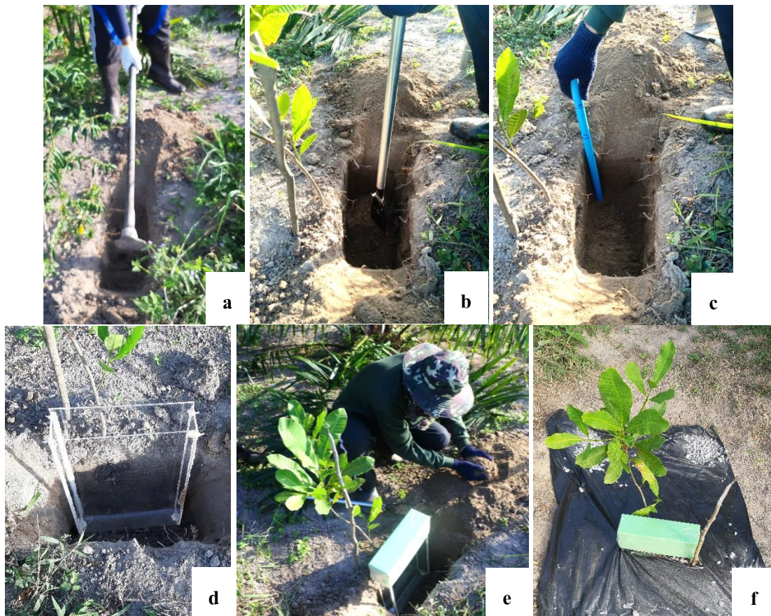
ภาพที่ 14 การติดตั้งอุปกรณ์บันทึกการเจริญเติบโตของราก การขุดหลุมด้วยจอบ (a) แต่งขอบหลุมด้วยเสียม (b) วัดความลึกหลุม (c) ใส่กล่องอะคริลิกลงในหลุม (d) ปิดฝากล่องอะคริลิกและกลบดินในหลุม (e) และปูแผ่นพลาสติกเพื่อป้องกันวัชพืช (f)
