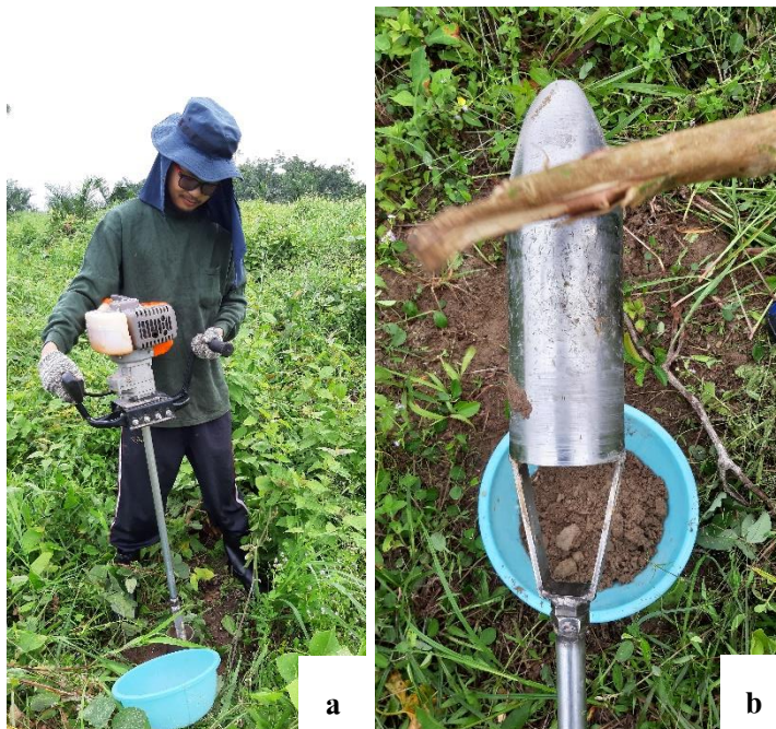
ภาพที่ 15 การเก็บตัวอย่างดินโดยใช้เครื่องเจาะดิน (a) ดินที่ได้จากการเก็บตัวอย่าง (b)
