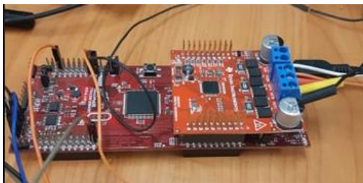
ภาพที่ 3.3 บอร์ด LAUNCHXL-F28069M (ด้านล่าง) และ DRV8305 (ด้านบน)
