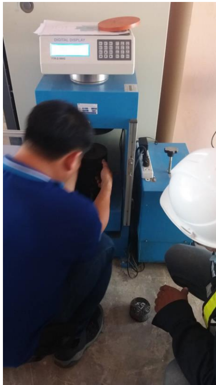
รูปที่ ๓.๓ ทดสอบหาค่ากำลังอัดของตัวอย่าง
