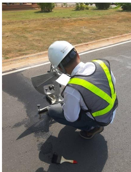
รูปที่ 3.16 การทดสอบการต้านทานการลื่นไถล
