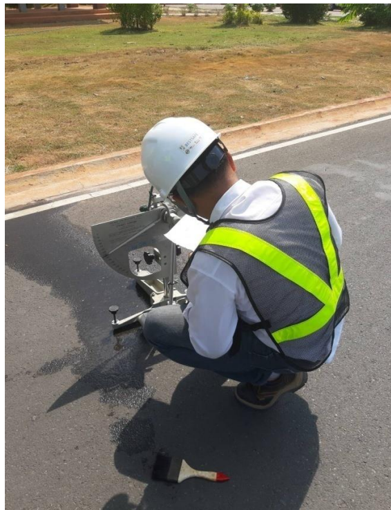
รูปที่ ฅ.4 ทดสอบการต้านทานทางการลื่นไถลบนฅิวทาง ที่ผสมน้ำยาง 10%
