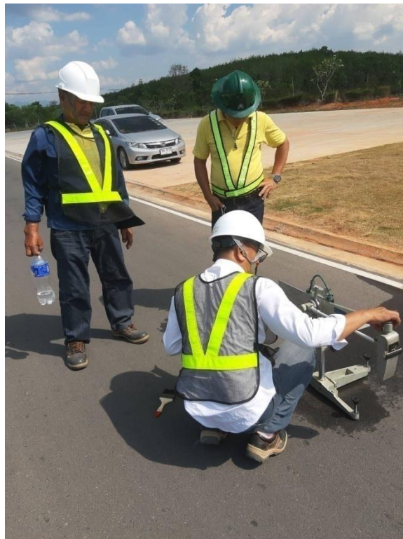
รูปที่ ฅ.2 ทดสอบการต้านทานการลื่นไถลบนผิวทาง ที่ผสมน้ำยางพารา 5%
