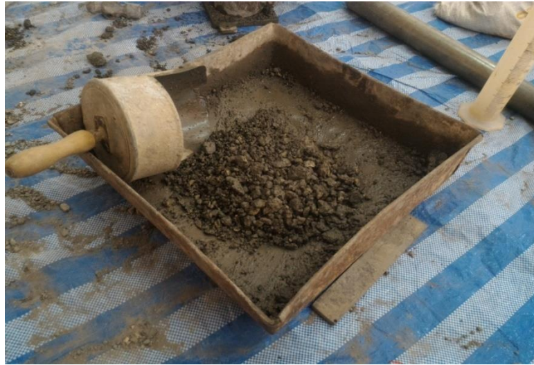
รูปที่ 3.3 เติมน้ำประมาณ 2% ของน้ำหนักแอสฟัลต์คอนกรีตเดิม
