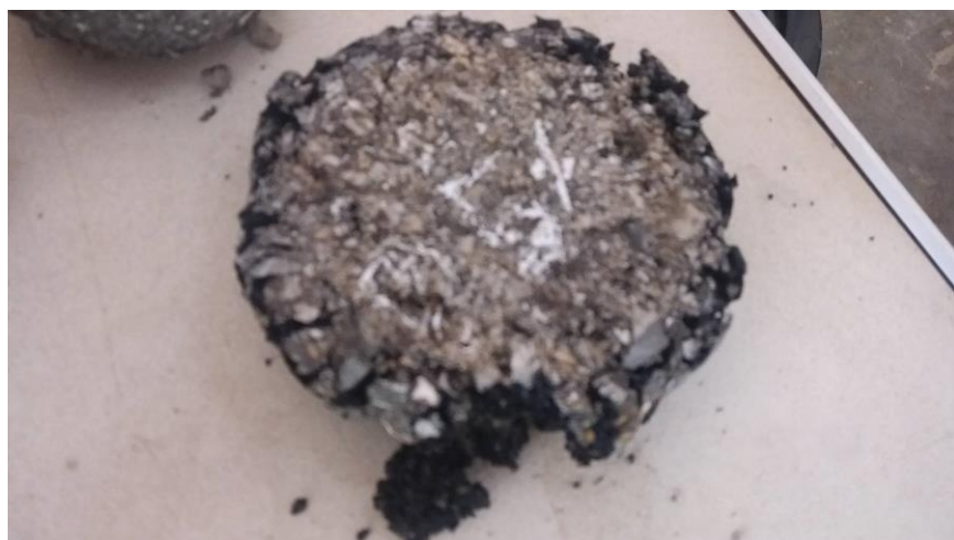
รูปที่ ๓.๔ ผิวนทางที่ได้ทดสอบหาค่ากำลังอัด
