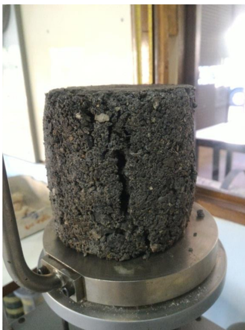
รูปที่ 3.14 ลักษณะการแตกของตัวอย่างเมื่อผ่านจุดพิบัติ
