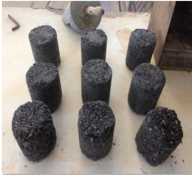
รูปที่ 3.12 วัดเส้นผ่านศูนย์กลาง ความสูง และชั่งน้ำหนัก
