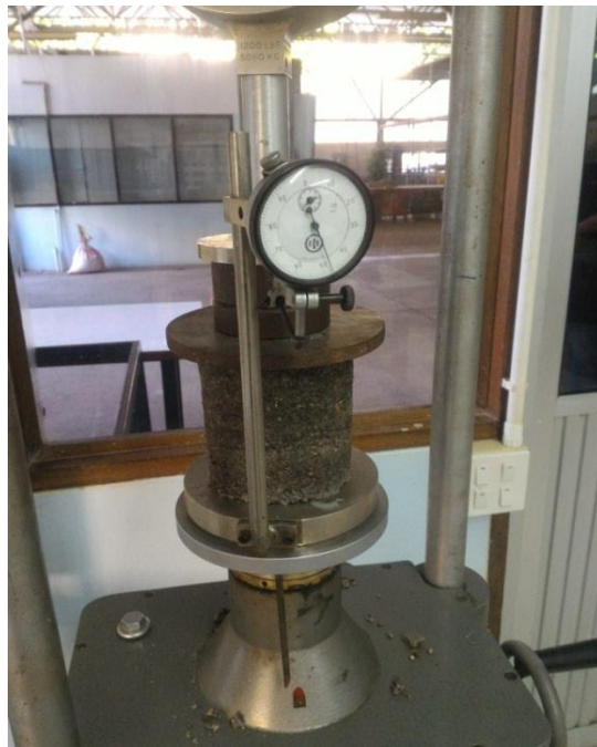
รูปที่ 3.13 การประกอบตัวอย่างเข้าเครื่องทดสอบ และติดตั้งอุปกรณ์ต่างๆ
