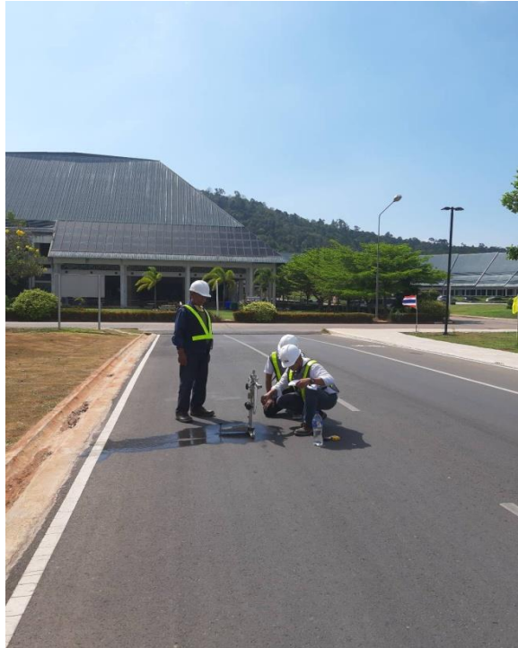
รูปที่ ฅ.3 ฅิวทางแอสฟัลต์คอนกรีตผสมน้ำยางพารา 10%
