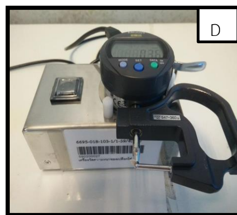
ภาพภาคผนวกที่ 16 แสดงการวัดคุณภาพของไข่ไก่โดยเครื่องมือวัดคุณภาพอัตโนมัติ Digital Egg Tester และเครื่องมือไมโครมิเตอร์ Shell Thickness Micrometer รูป A คือ น้ำหนักของไข่ไก่ รูป B คือ วัดความแข็งแรงของเปลือกไข่ รูป C คือ สีไข่แดง รูป D คือ ความหนาของเปลือกไข่
