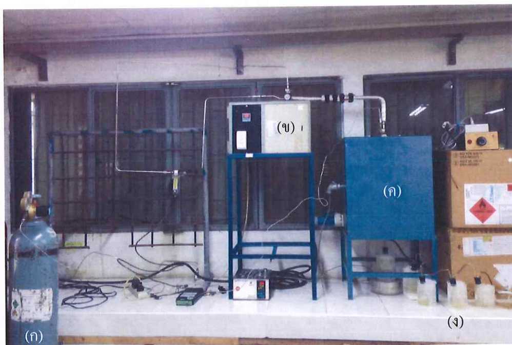
ภาพประกอบ 3-10 อุปกรณ์สำหรับการไพโรไลซิสในห้องทดลอง (ก) ถังไนโตรเจน (ข) เต้าปฏิกิริยาสำหรับการไพโรไลซิส (ค) เต้าปฏิกิริยาสำหรับตัวเร่งปฏิกิริยา (ง) เครื่องควบแน่นกับดักน้ำแข็ง
