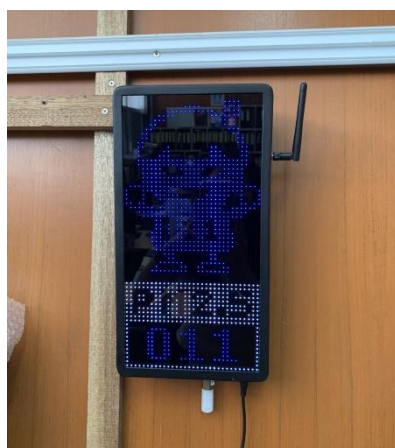
ภาพประกอบ 5 : ภาพอุปกรณ์ตรวจวัดมลพิษทางอากาศ ฝุ่น PM 2.5 ทั้ง 2 แบบ ที่มา : ภาพจากงานวิจัย
