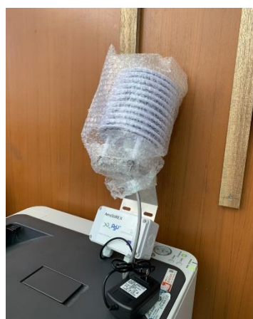
ภาพประกอบ 5 : ภาพอุปกรณ์ตรวจวัดมลพิษทางอากาศ ฝุ่น PM 2.5 ทั้ง 2 แบบ ที่มา : ภาพจากงานวิจัย
