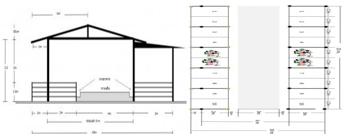
ภาพที่ 3 ตัวอย่างคอกโคขุนแบบผูกยืนโรง ที่มา : ดัดแปลงจาก โชค (2551)
