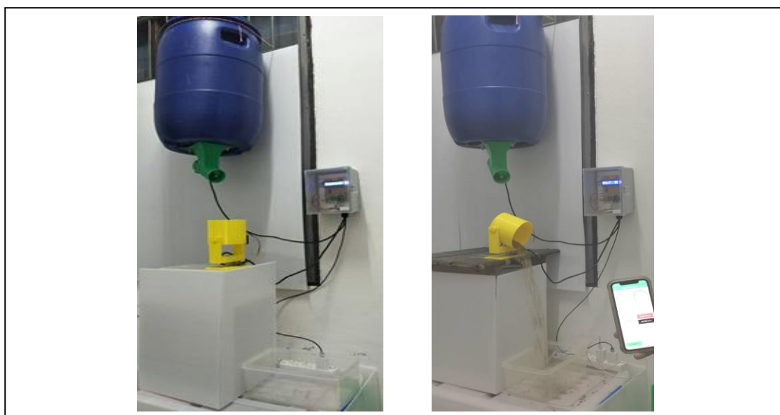
ภาพที่ 16 ระบบให้อาหารม้าแบบอัตโนมัติด้วยไอโอที พัฒนาแล้วเสร็จ
