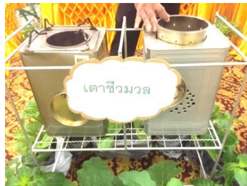
ภาพประกอบที่ 3 เต้าชีวมวล ทำจากป๊อป ที่มา: ถ่ายภาพโดยผู้วิจัย วันที่ 5 มกราคม 2561
