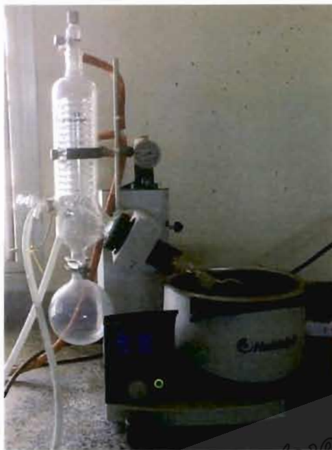
รูปที่ 3.6 เครื่องระเหยสารแบบสูญญากาศ Heidolph รุ่น Hei-VAP Advantage
