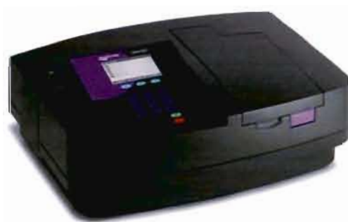
รูปที่ 3.3 เครื่องสเปกโทรโฟโตมิเตอร์ รุ่น LIBRA S22
