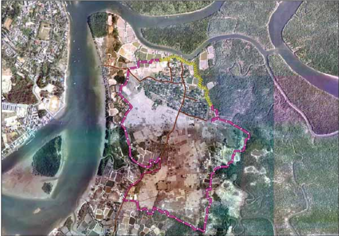
รูปที่ 4-9 แนวคั่นกันน้ำที่กลุ่มชาวบ้านคลองประสงค์เสนอเป็นระยะทาง 6.7 กิโลเมตร (เส้นสีม่วง) และสำนักพัฒนาที่ดินเขต 11 สนับสนุนงบประมาณเพื่อก่อสร้าง แนวสีเหลืองคือพื้นที่สูงซึ่งใช้เป็นแนวป้องกันตามธรรมชาติ
